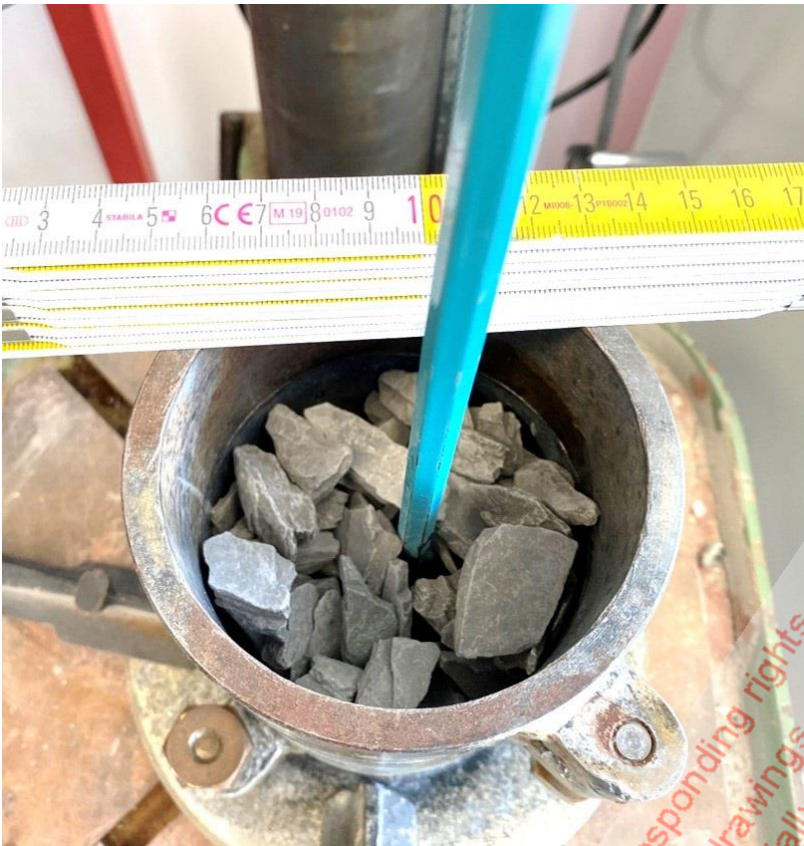
Bild 21: Lias \alpha , Tastversuch zur Verbreitung/Verklebung an 24 h bei 60 °C getrockneten Gesteinsstücken
