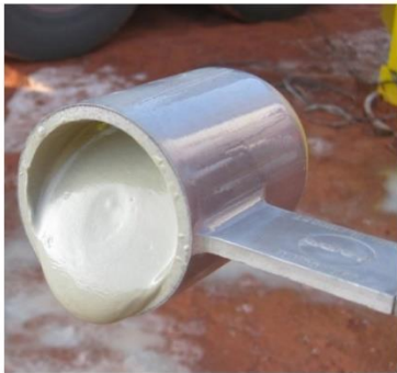
Bild 2: Abdichten von Klüften mit großer Spaltweite, Zementpaste
