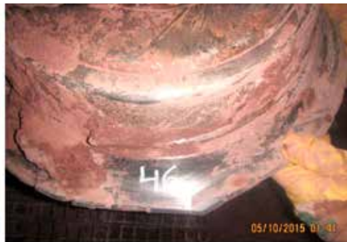
Filder tunnel Meißel, einseitige Abnutzung bei Blockade / one-sided cutter disc wear due to blockage
