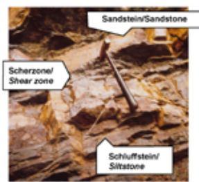
Wechsellagerung mit gefüllten Scherzonen/ Alternating sequence with filled shear zones
