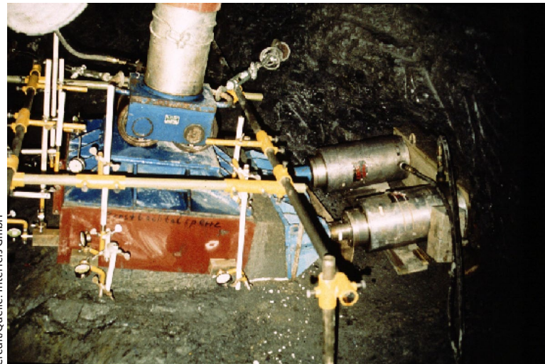
17 In situ shear test Großscherversuch
